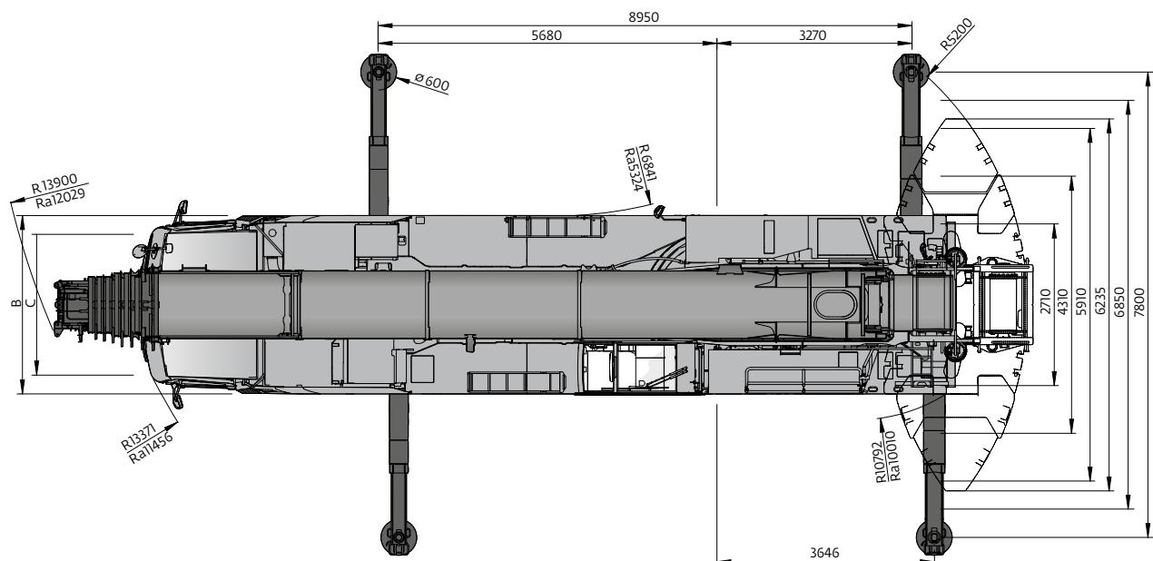
R<sub>a</sub> = Radius all wheels steered • Radius allradgelenkt • Rayon toutes les roues directrices • Radio de giro con todas las ruedas giradas • Raggio di curva con tutte le ruote sterzate
